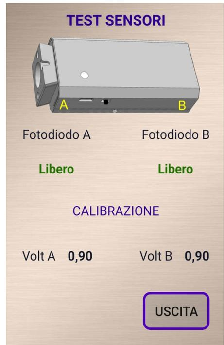
**Pulizia led e fotodiodi:** con il tempo i fotodiodi si possono ricoprire di polvere di piombo e grassi, in tal caso l'app vi mostrerà un messaggio dove vi inviterà a fare la pulizia. Sarà sufficiente passare sui led e fotodiodi un cotton fioc leggermente imbevuto di alcool.
