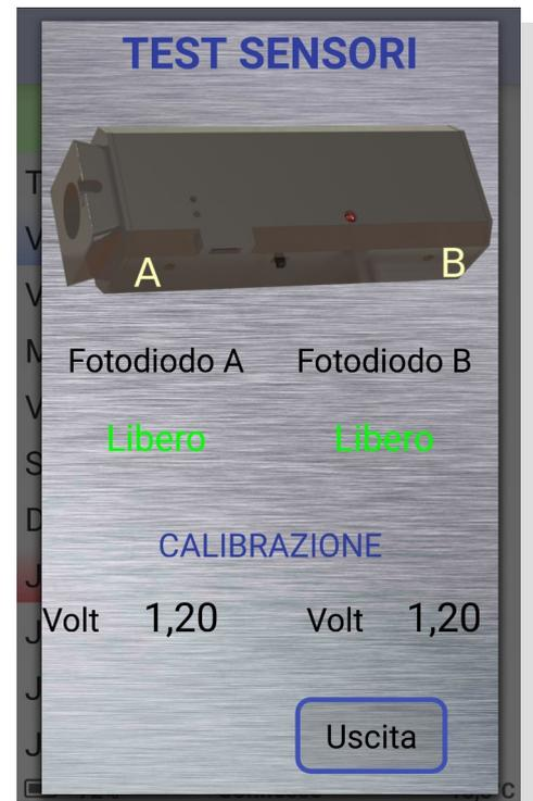
**Pulizia led e fotodiodi:** con il tempo i fotodiodi si possono ricoprire di polvere di piombo e grassi, in tal caso l'app vi mostrerà un messaggio dove vi inviterà a fare la pulizia.
