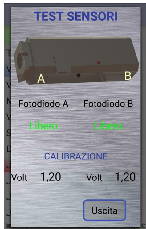
**Pulizia led e fotodiodi:** con il tempo i fotodiodi si possono ricoprire di polvere di piombo e grassi, in tal caso l'app vi mostrerà un messaggio dove vi inviterà a fare la pulizia.
