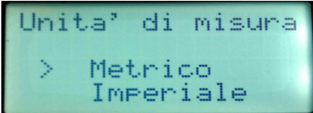
Con i tasti '+' e '-' si seleziona l'unità e con Enter si esegue il cambio e si ritorna alla schermata principale visualizzando i dati con la nuova unità.
